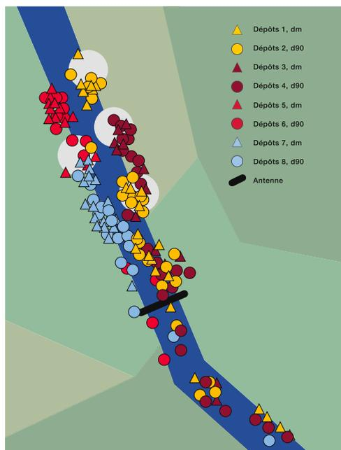
**Répartition des matériaux de charriage issus des quatre dépôts de gravier après la crue. Les dépôts repérés en jaune et en bleu ont été érodés à peu près de moitié, alors que ceux en rouge n'ont quasiment pas bougé et les violets ont été presque totalement déplacés (illustration schématique).** *Source : Projet « Gestion durable des zones inondables et force hydraulique »*
