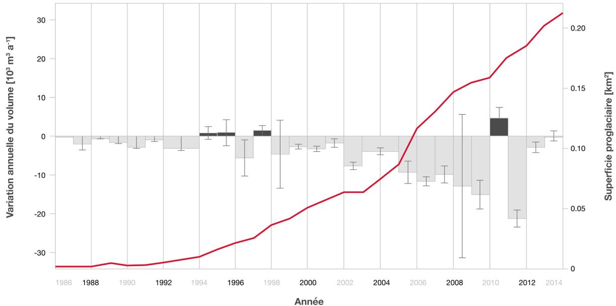
**Augmentation des surfaces libérées par la glace à proximité du glacier de Gries, dans le canton du Valais et évolution du transport de sédiments entre 1986 et 2014.** *Source : Projet « Zones périglaciaires et hydroélectricité »*
