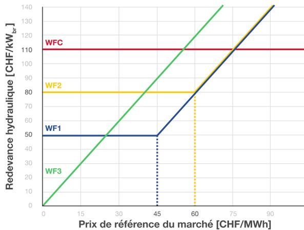
**WF1, WF2 et WF3** représentent trois mises en application différentes d'un modèle de redevance hydraulique flexible. **WF1 et WF2** se caractérisent par un montant de base et un prix de marché de référence différents, pour lesquels la part variable commence à faire son effet. **WF3** est un scénario sans montant de base. **WFC** correspond au modèle figé actuel, avec une redevance hydraulique maximale constante. *Source : Projet « L'avenir de l'énergie hydroélectrique en Suisse »*
