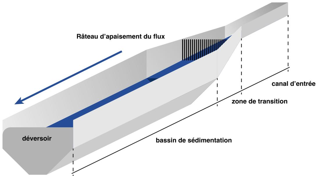
**Représentation schématique d'un dessableur avec le canal d'entrée, la zone de transition, le bassin de sédimentation, le déversoir et le râteau d'apaisement du flux.**
