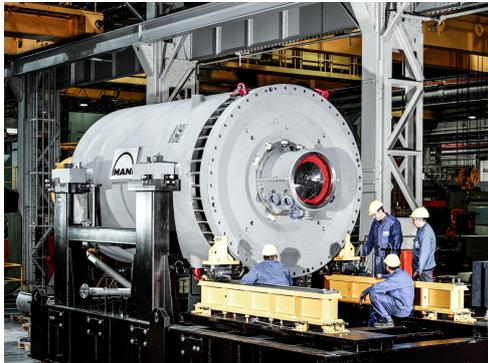
**La longueur du compresseur radial est de 4 mètres environ et son diamètre de 3 mètres environ.** *Source : MAN Energy Solutions AG*
