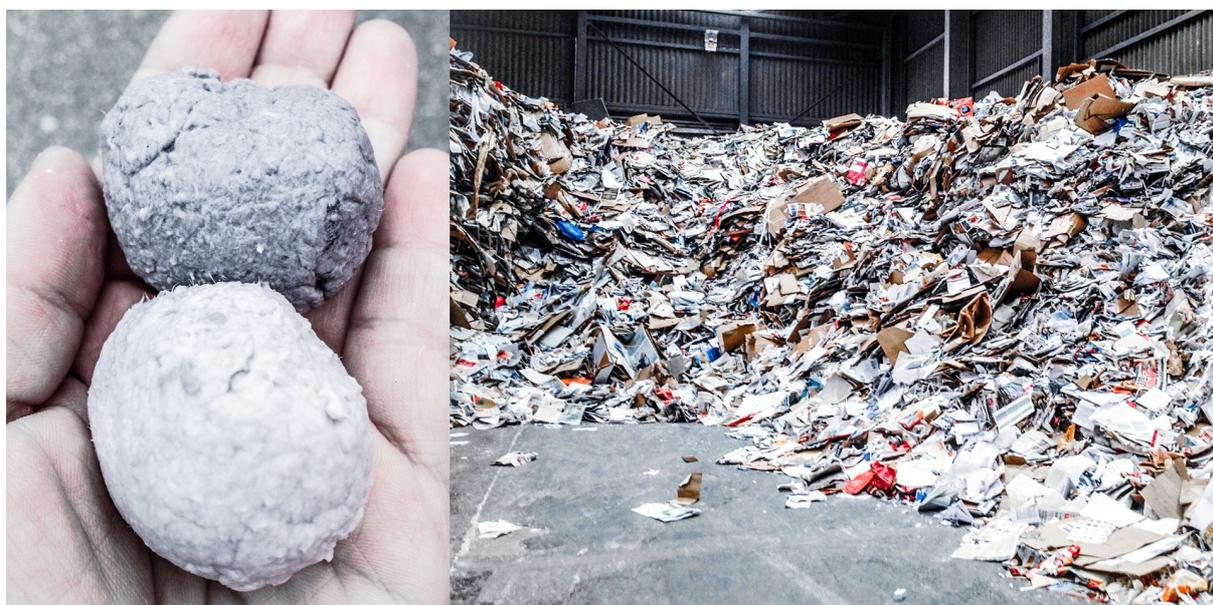
**À gauche : Fibres issues du recyclage du papier, avant et après le désencrage. À droite : Stockage d'un mélange de vieux papier et de carton usagé dans l'ancienne papeterie Utzenstorf AG. Source : Melanie Haupt, ETH Zürich.**
