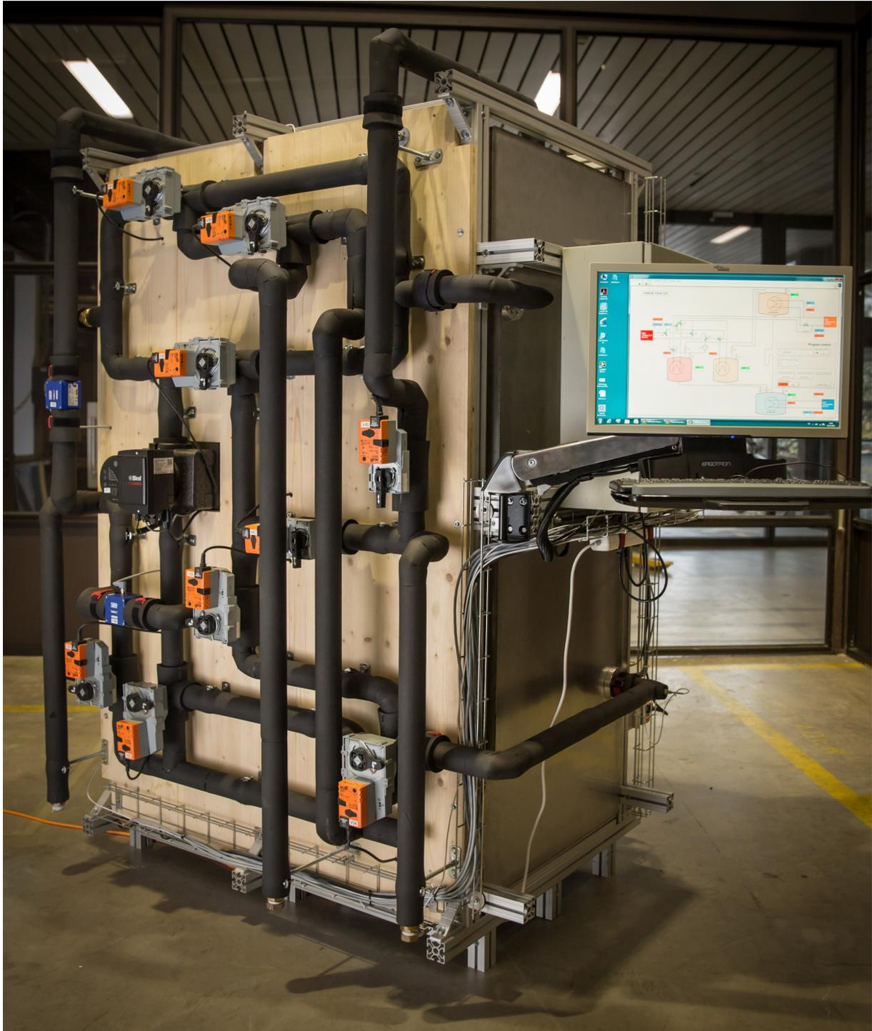
La nouvelle pompe à chaleur d'adsorption : ces installations doivent utiliser à l'avenir la chaleur dissipée pour le chauffage et le refroidissement. *Source* : Institut de technique solaire, HSR
