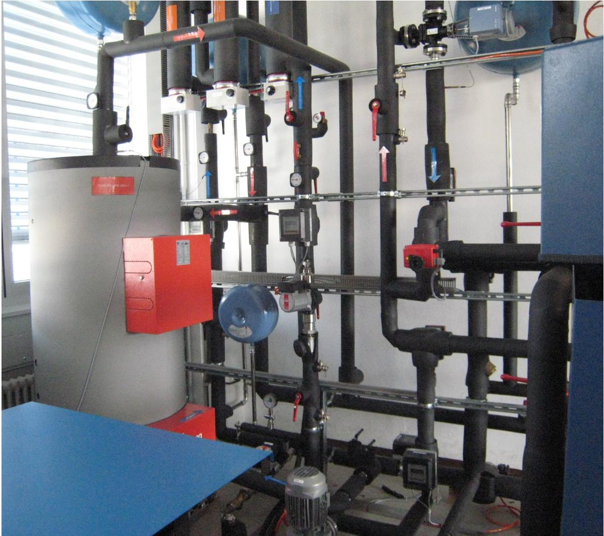
Essais en laboratoire : un système thermohydraulique simule le fonctionnement d'une pompe à chaleur d'adsorption.
