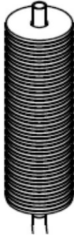
Dans la pompe à chaleur, les disques de carbone sont collés entre des plaques de cuivre conductrices de chaleur et empilés autour du tuyau de fluide frigorigène. La conception de ces éléments d'échangeur de chaleur est aussi importante pour le fonctionnement de la pompe à chaleur que les performances du matériau. IBM/HSR
