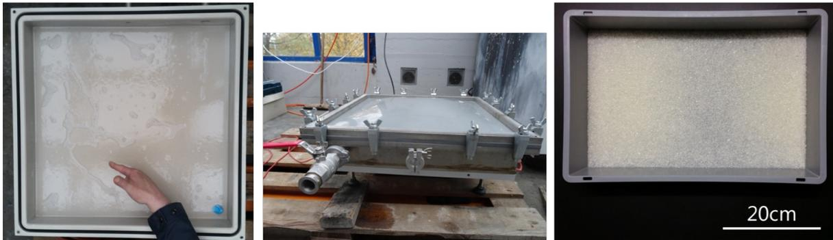
Fabrication du gel de silice amélioré : de la suspension (à gauche) aux billes de silice, en passant par le séchage. Empa
