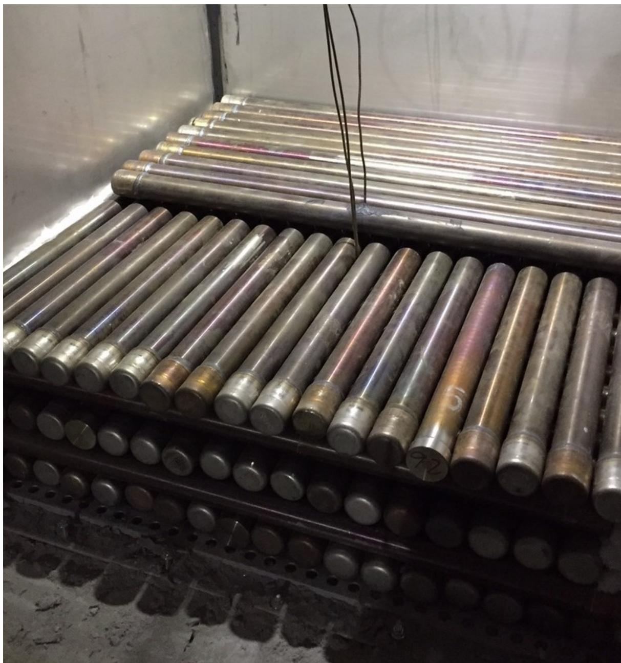
Ce système de stockage d'énergie thermique latente permet de capter la chaleur et de stocker l'électricité plus efficacement. *Source* : Viola Becattini
