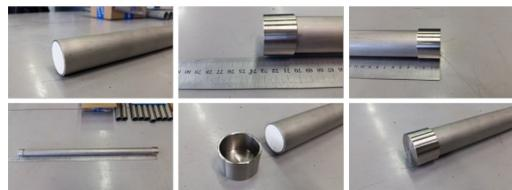
Un tube d'acier rempli du matériau à changement de phase en laboratoire.
