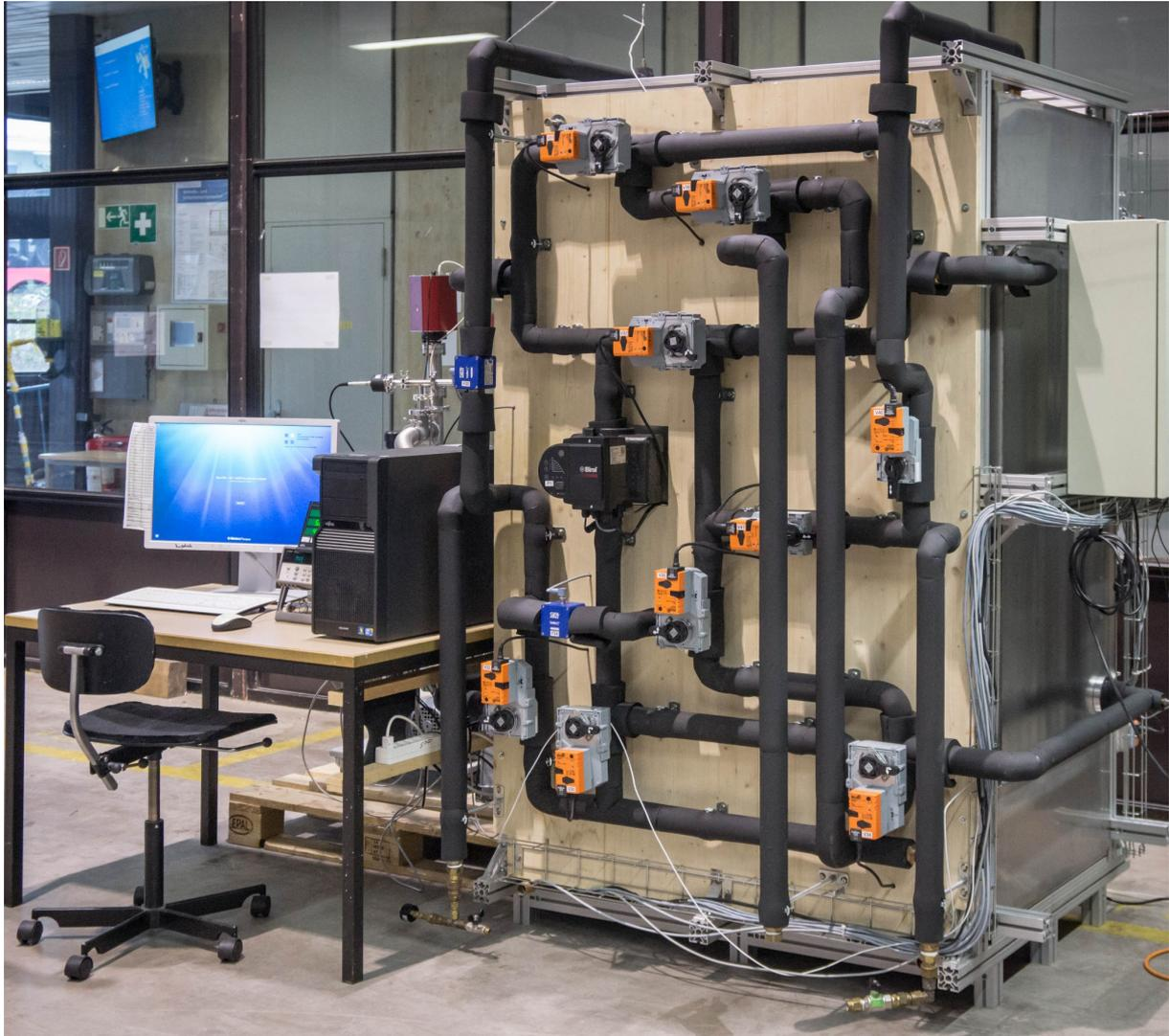
Prototype des nouvelles pompes à chaleur d'adsorption. Ces équipements permettent de tirer profit de la chaleur dissipée par exemple par les usines. *Source* : Institut für Solartechnik
