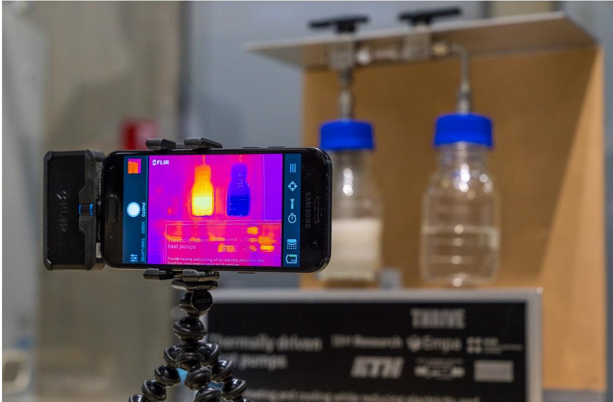
Visualisation de la chaleur : une caméra infrarouge met en évidence les différences de température durant un processus d'adsorption. Institut für Solartechnik, HSR
