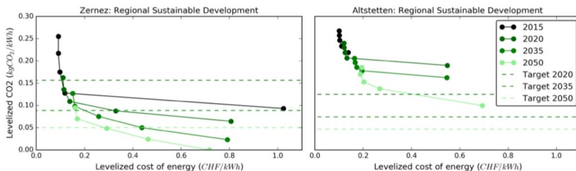
Les calculs montrent les futurs effets des hubs multi-énergies sur les émissions de CO<sub>2</sub> et le coût de l'énergie : à Zerne, les objectifs de la Stratégie énergétique 2050 seraient tenus. Altstetten
