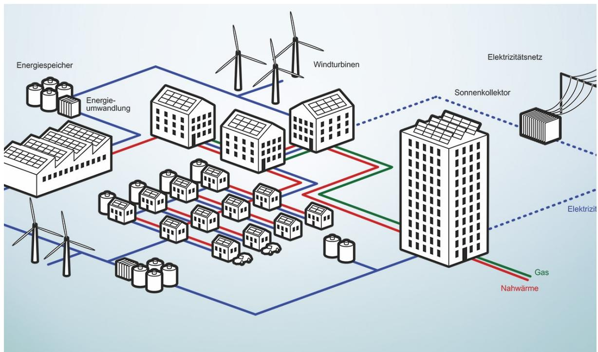
L'approvisionnement énergétique du futur : dans les systèmes multi-énergies, les centrales électriques, les solutions de stockage et les consommateurs sont interconnectés. *Source : Sandro Bösch/ETH Zürich*
