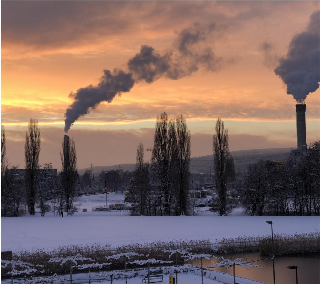
Même les déchets ont un bon côté : la chaleur dissipée par l'usine d'incinération des ordures ménagères de Hagenholz à Zurich (à droite) est récupérée et exploitée. En combinaison avec la centrale de chauffage au bois d'Aubrugg (à gauche sur la photo), l'installation couvre la majeure partie des besoins du réseau de chauffage urbain de la ville de Zurich. *Source* : Melanie Haupt, ETH Zürich
