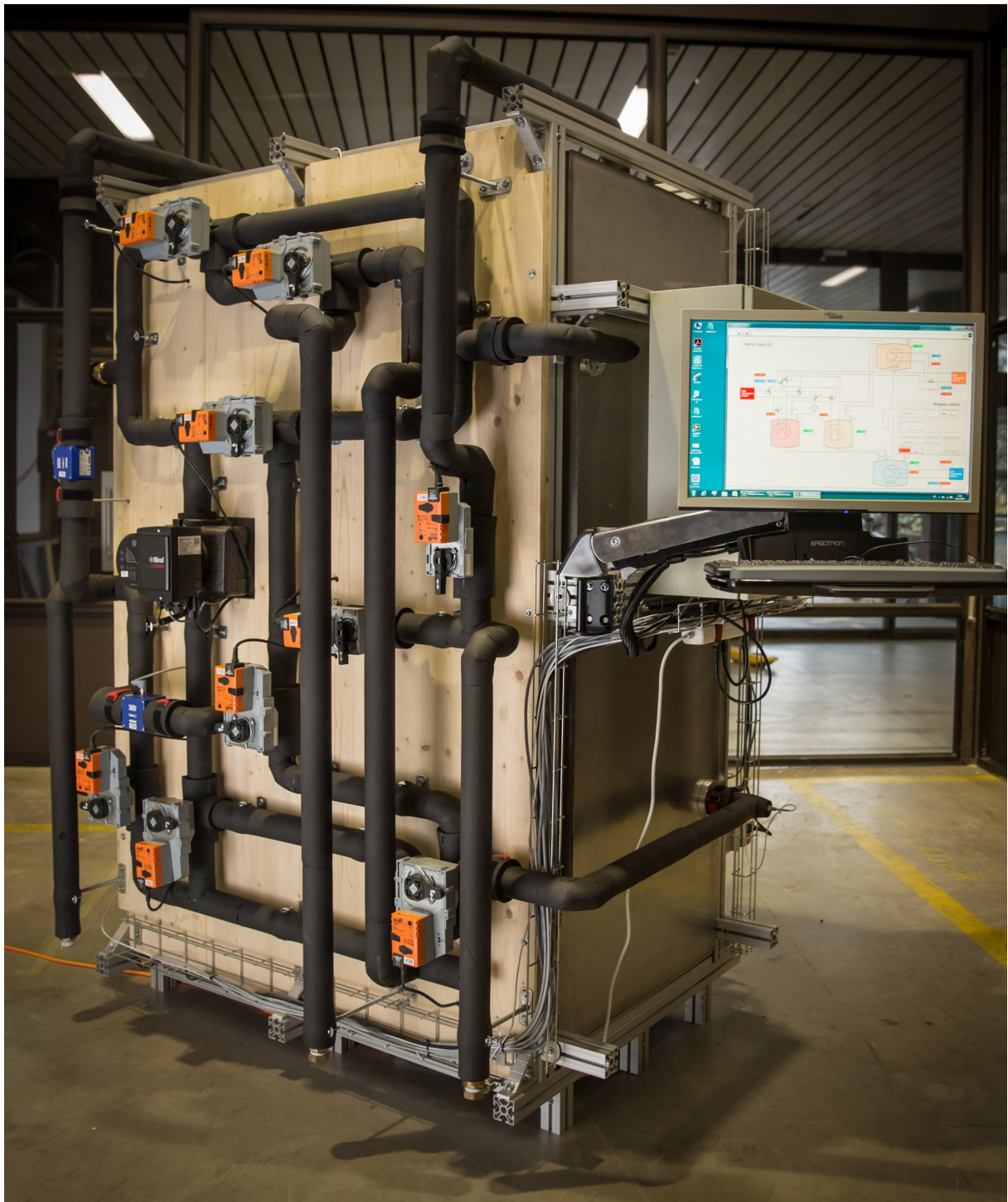
La nouvelle pompe à chaleur d'adsorption : ces installations doivent utiliser à l'avenir la chaleur dissipée pour le chauffage et le refroidissement. Source : Institut de technique solaire, HSR
