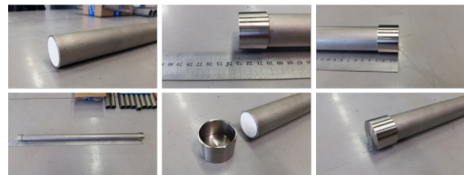
Un tube d'acier rempli du matériau à changement de phase en laboratoire. Sophia Haussener
