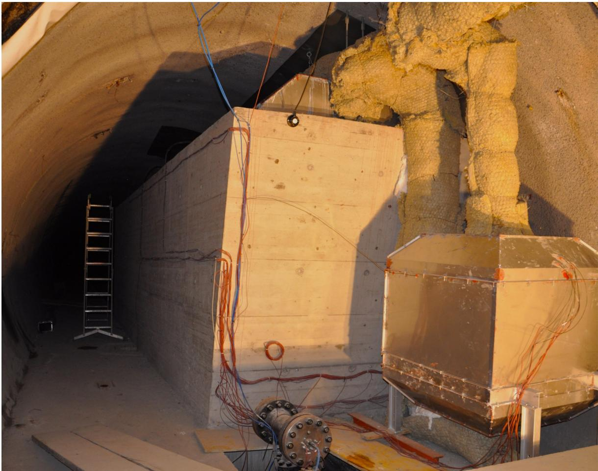
Le stockage d'énergie au moyen d'air comprimé devient efficace lorsque la chaleur de compression est également stockée. Tel est le cas dans cette installation pilote munie de réservoirs de stockage pour la chaleur latente (au premier plan) et la chaleur sensible (en arrière-plan). *Source : Viola Beccatini*
