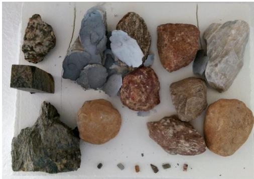
Les chercheurs ont testé différents types de pierres pour le système de stockage d'énergie thermique. Viola Becattini
