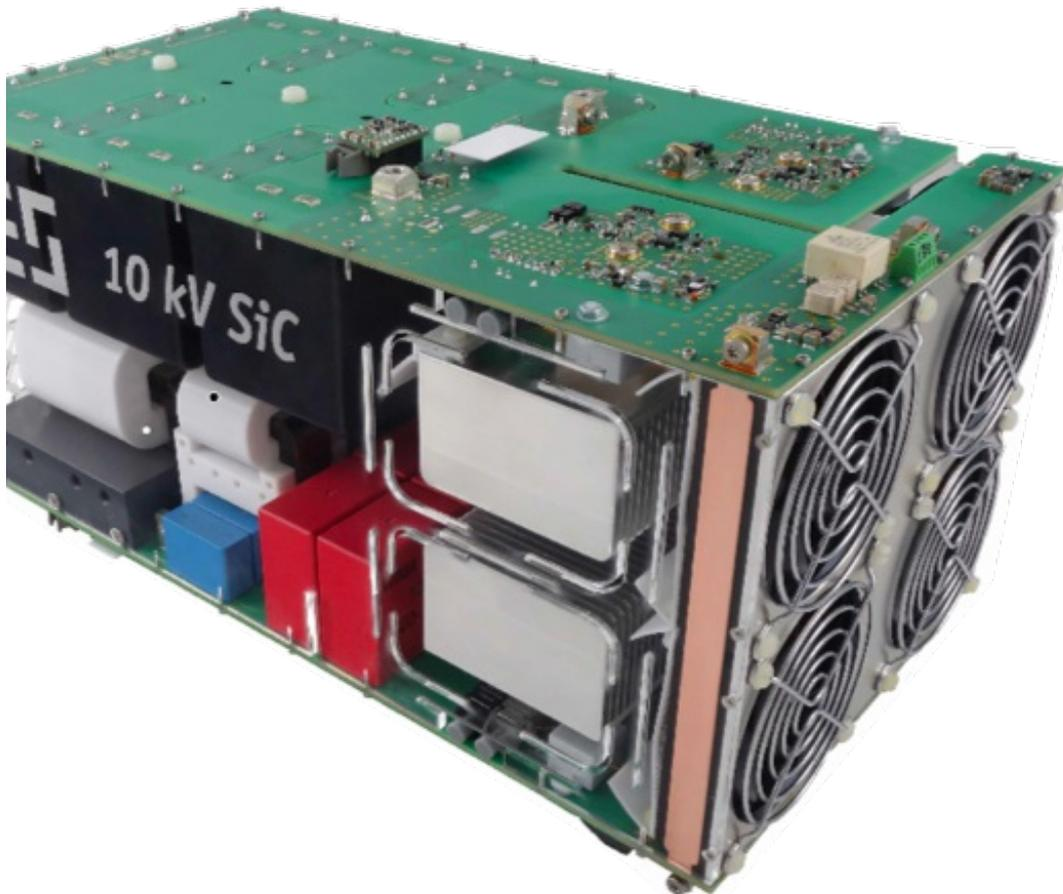
Grâce à sa conception compacte et efficace, un transformateur électronique de puissance SST développé à l'EPF de Zurich donne un avant-goût de l'avenir de l'approvisionnement en énergie électrique. *Source : ETHZ*
