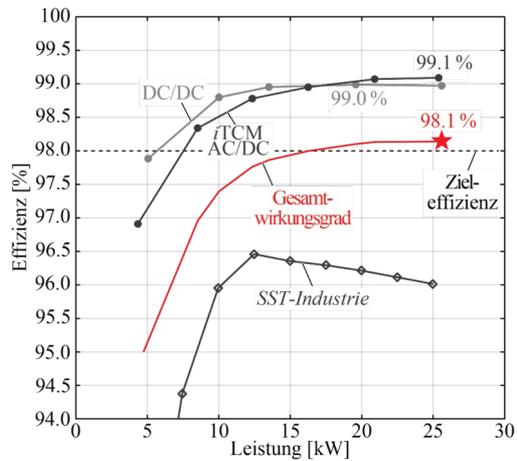
Avec un rendement d'environ 99 % pour chacune des deux phases de conversion (deux courbes supérieures) et un rendement global d'au moins 98 % (courbe rouge), le transformateur de l'EPF fait nettement mieux que les équipements industriels comparables. Rothmund et al.
