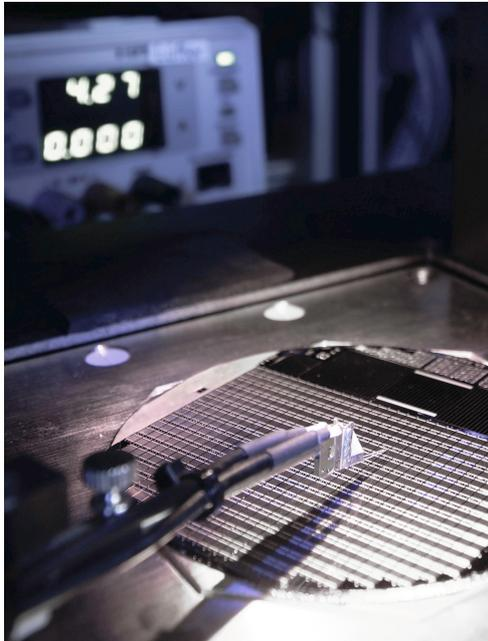
**Neue Weltrekordsolarzelle auf einem 100 mm Wafer mit ungefähr 500 Konzentrazorzellen.** *Quelle: Fraunhofer ISE / Foto Alexander Weckel.*
