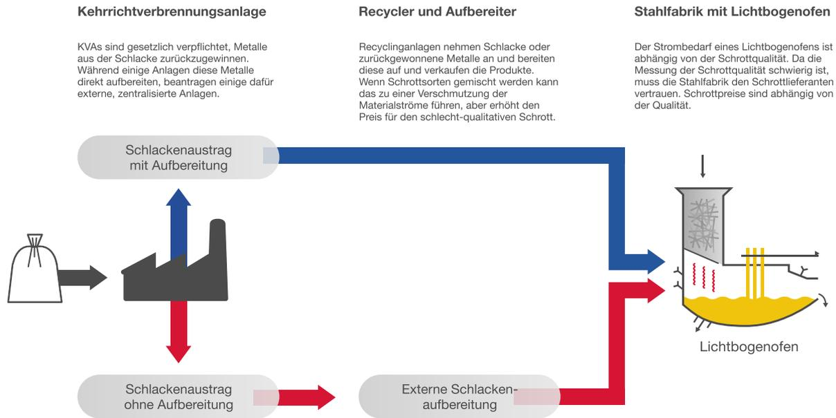
**Wertschöpfungskette am Beispiel von Stahlschrott aus der KVA. Die KVA, die Recycler und die Aufbereiter üben einen grossen Einfluss auf die Materialqualität aus. Das Stahlwerk hingegen ist stark von den anderen Akteuren abhängig, da der Stromverbrauch und die Stahlqualität von der Qualität des Schrottes abhängen. Quelle: Melanie Haupt, ETH Zürich**
