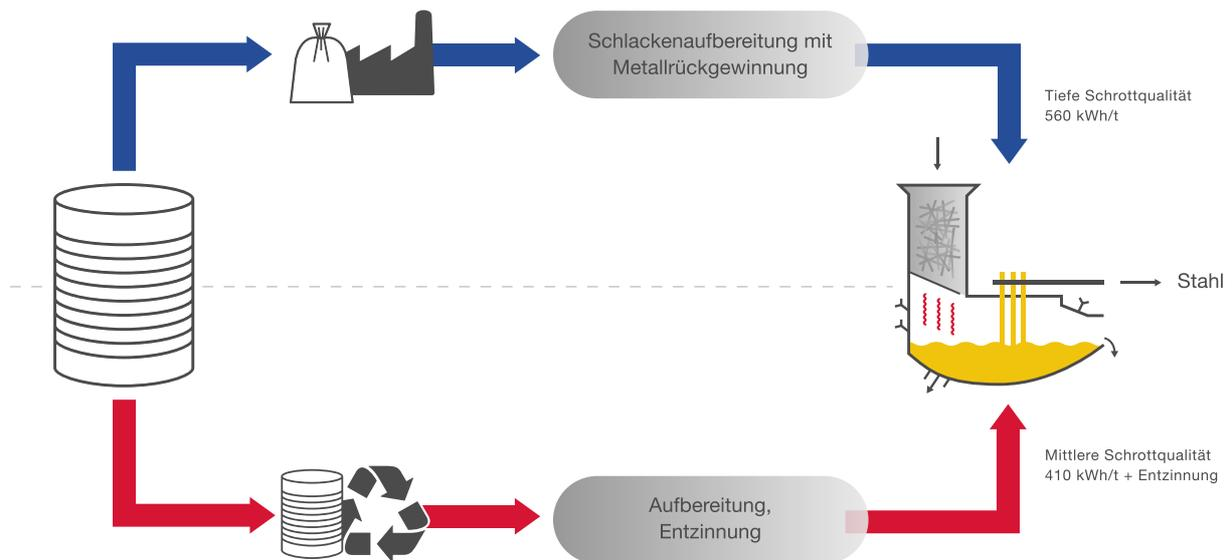
**Der Einfluss der Qualität beim Weissblechrecycling. Während aus einer separaten Sammlung mittlere Schrottqualitäten resultieren, ist Schrott aus der KVA (ohne nachfolgende Aufbereitung) von tiefer Qualität. Dies hat grossen Einfluss auf den Stromverbrauch im Recycling. Quelle: Melanie Haupt, ETH Zürich (basierend auf Haupt et al. [2017])**
