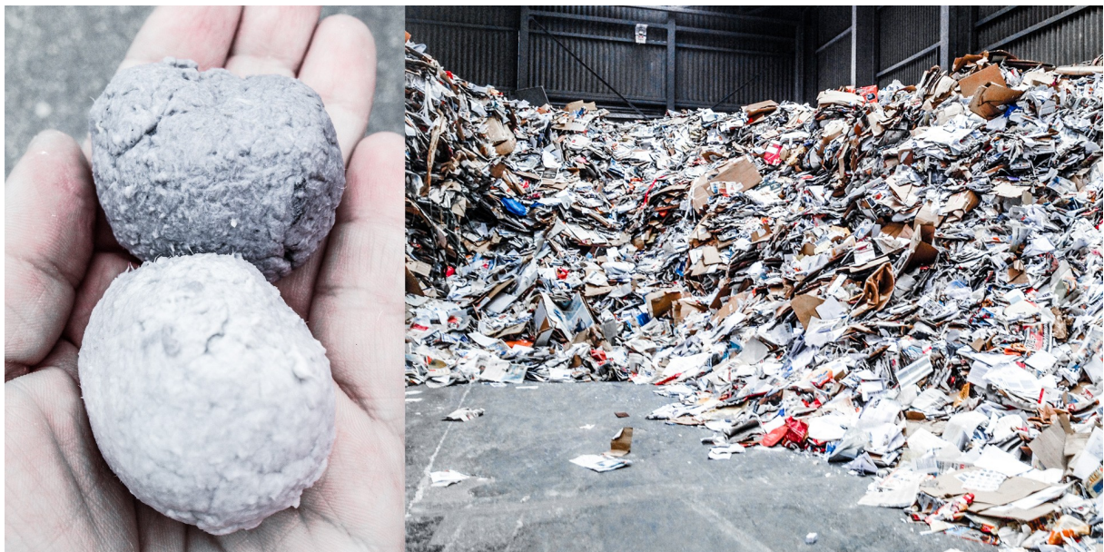
Abbildung links: Faserstoff aus Papierrecycling vor und nach der Druckfarbenentfernung. Abbildung rechts: Lagerhalle mit gemischtem Altpapier und Altkarton bei der ehemaligen Papierfabrik Utzenstorf AG Quelle: Melanie Haupt, ETH Zürich
