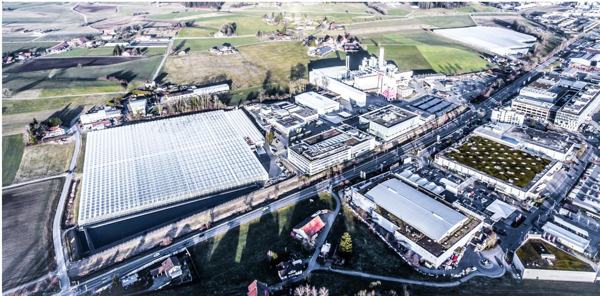
**Die Kehrichtverwertungsanlage als Kraftwerk: Bei der KEZO in Hinwil sind zwei grosse Treibhäuser angeschlossen, die die Wärme der Kehrichtverbrennung nutzen. Zudem wird in dieser KVA auch Strom produziert.** *Quelle: Christian Merz*
