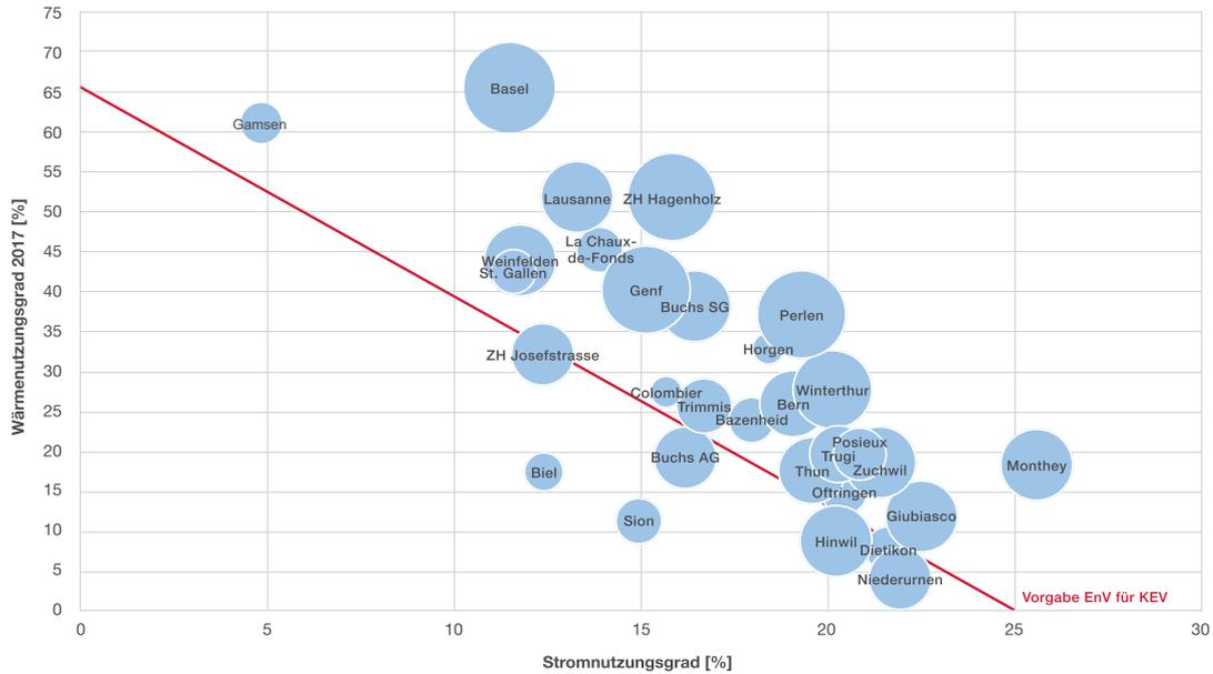
**Netto Wärme- und Stromnutzungsgrade der Schweizer Kehrichtverbrennungsanlagen im Jahr 2017. EnV = Schweizerische Energieverordnung, KEV = Kostendeckende Einspeisevergütung. Quelle: Ryttec (2018), angepasst von Melanie Haupt, ETH Zürich**
