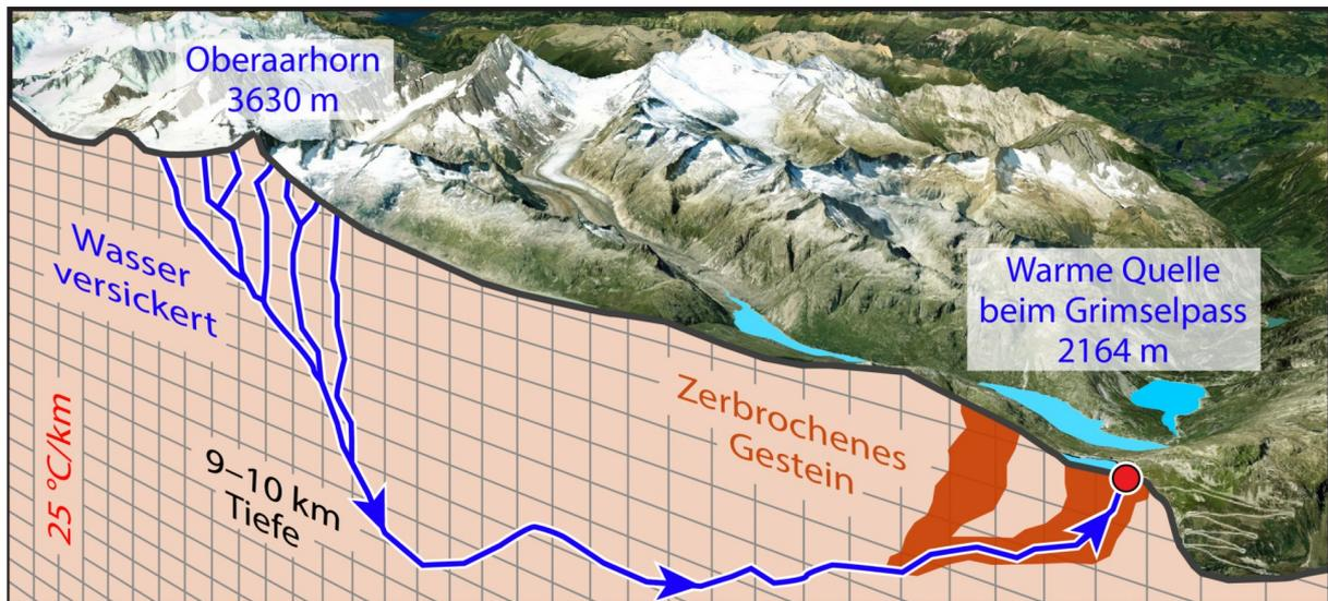
Schematische Skizze der unterirdischen Fließwege von Thermalwasser beim Grimselpass.
