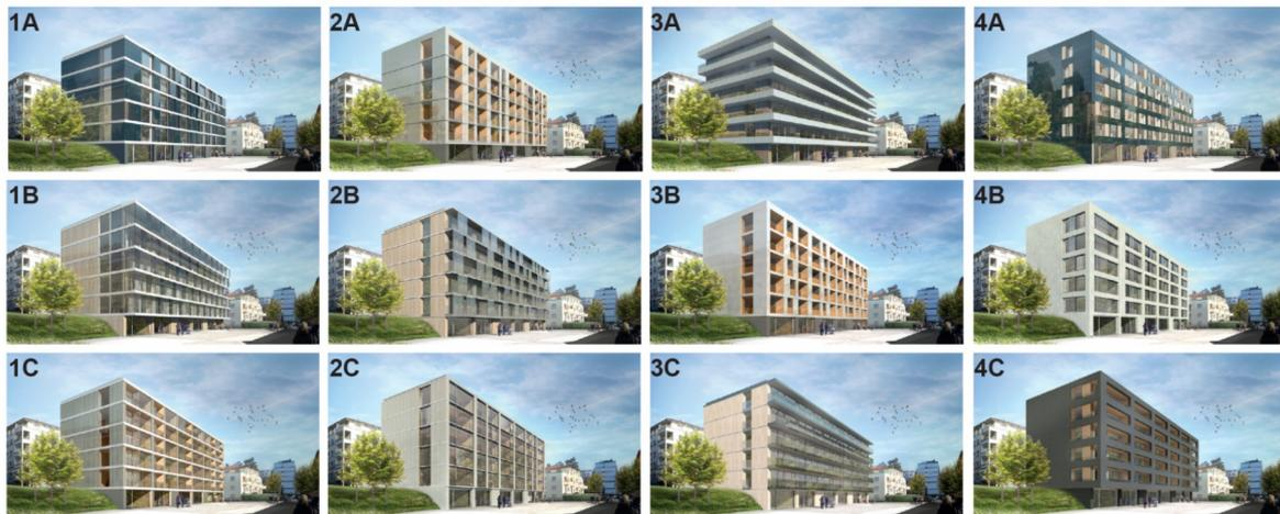
Mit den neuen GiPV-Modulen lassen sich Fassaden mit ganz unterschiedlicher Optik verwirklichen. Je nach Gestaltung fällt auch die Energiebilanz unterschiedlich aus.
