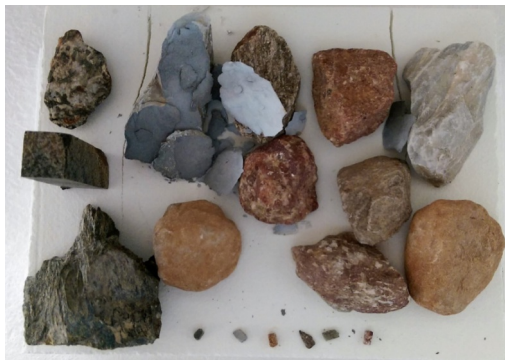
Für den Wärmespeicher testeten die Forschenden verschiedene Steinsorten. Viola Beccatini
