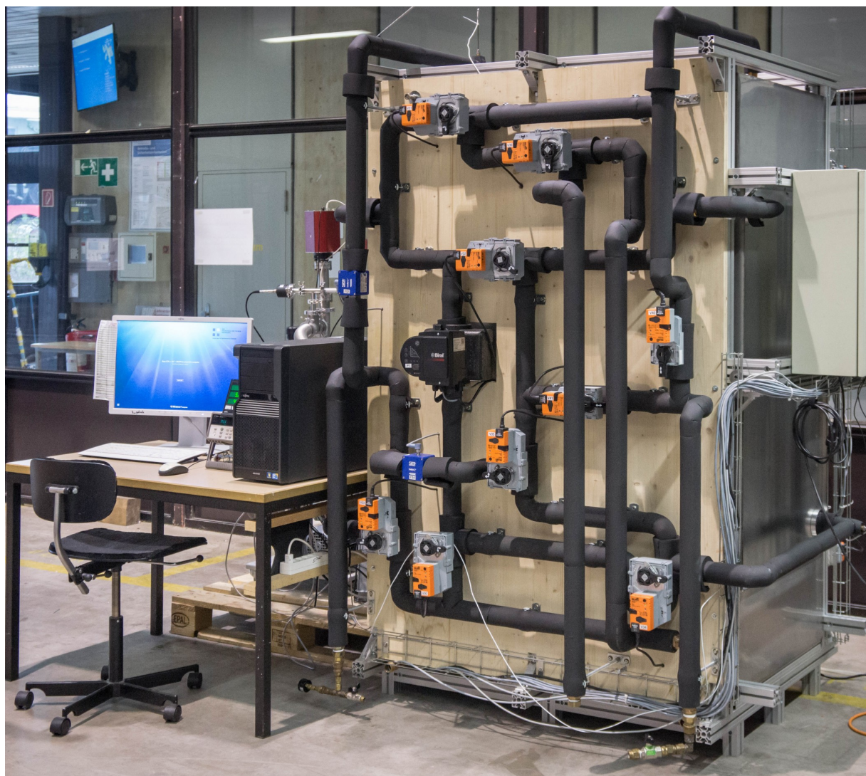
Der Prototyp der neu entwickelten Adsorptionswärmepumpe. Solche Anlagen könnten künftig beispielsweise Abwärme von Fabriken nutzen. Quelle: Institut für Solartechnik
