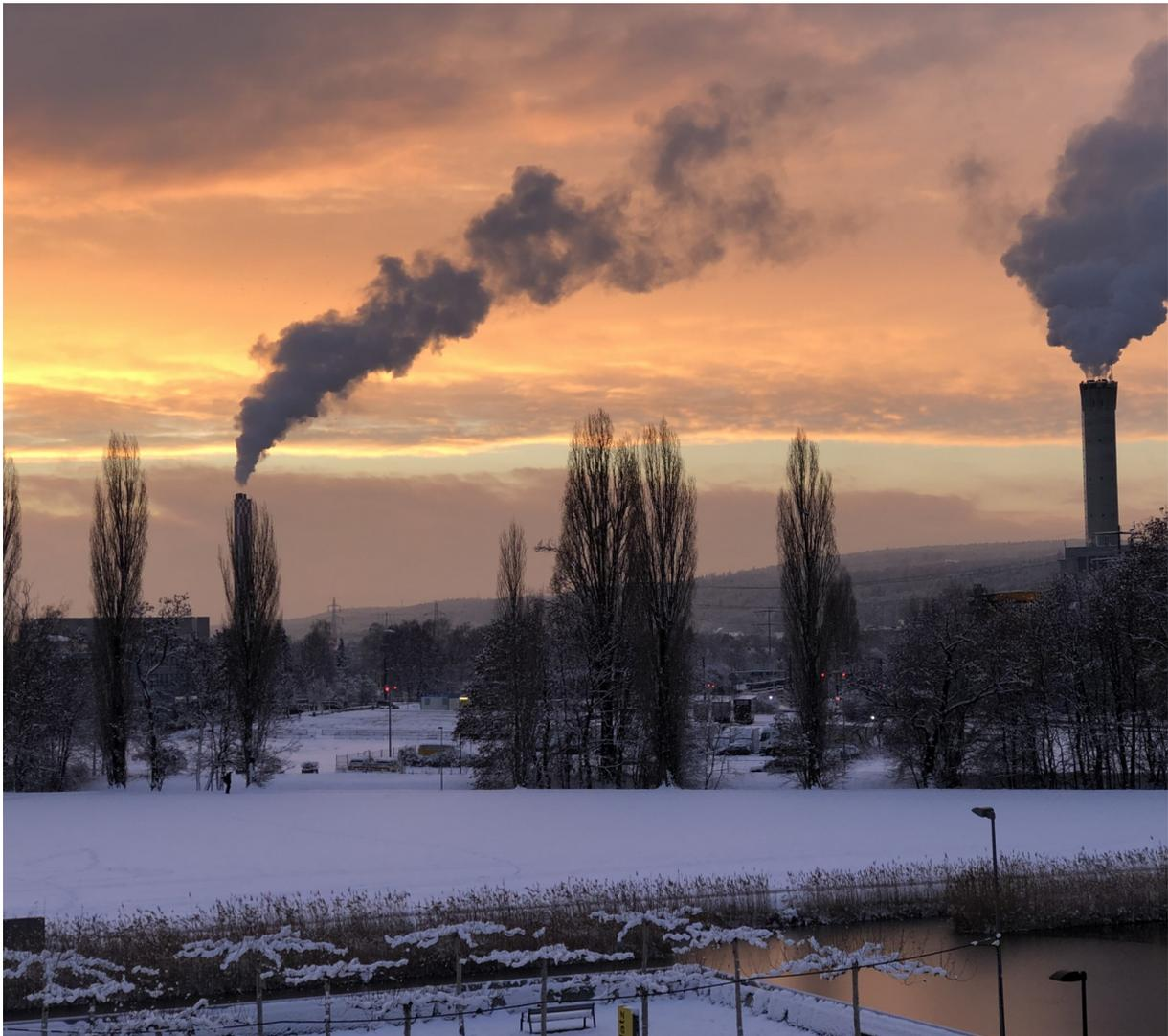
Die schöne Seite des Abfalls: In der Kehrichtverbrennungsanlage Hagenholz in Zürich (rechts) wird die Verbrennungswärme aufgefangen und genutzt. Gemeinsam mit dem Holzheizkraftwerk Aubrugg (links im Bild) versorgt die Anlage den grössten Teil des Fernwärmenetzes der Stadt Zürich. *Quelle:* Melanie Haupt, ETH Zürich
