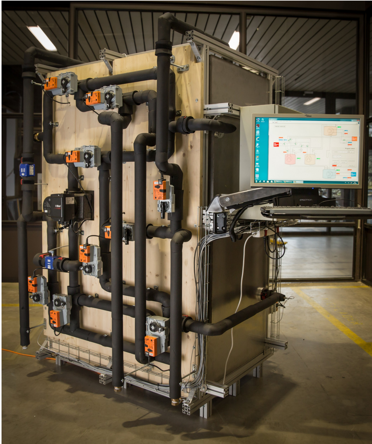
Die neu entwickelte Adsorptionswärmepumpe: Solche Anlagen sollen in Zukunft Abwärme zum Heizen und Kühlen nutzen. Quelle: Institut für Solartechnik, HSR
