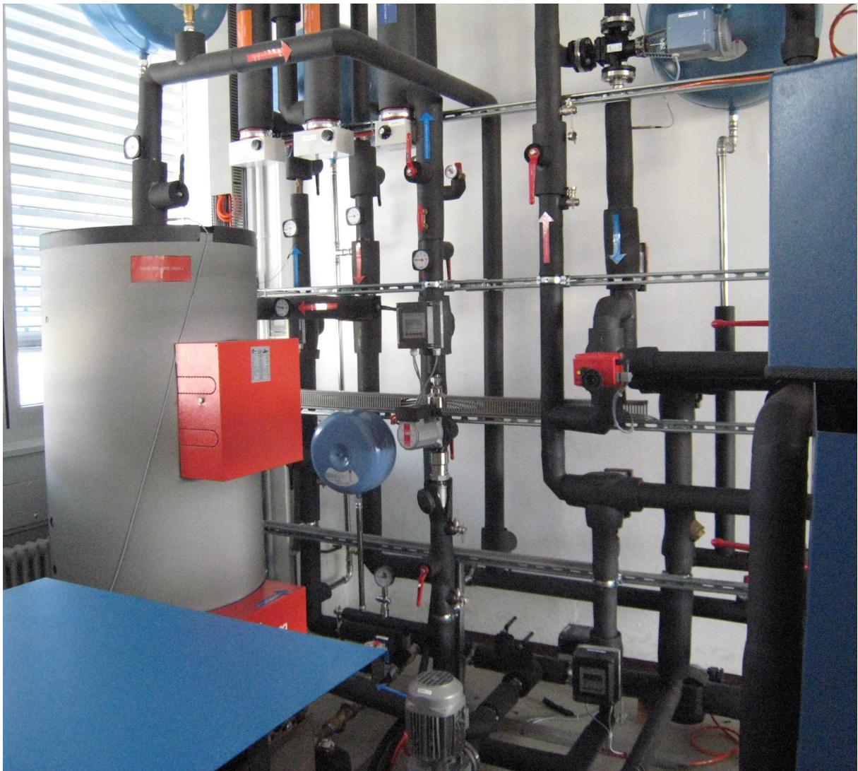
Für Versuche im Labor: Die thermohydraulische Anlage simuliert die Funktionsweise einer Adsorptionswärmepumpe. Quelle: HEIG-VD
