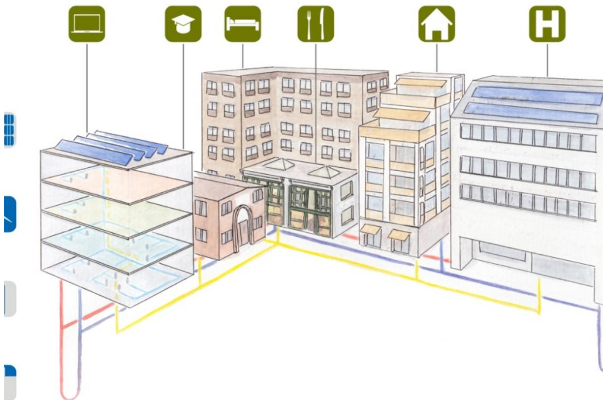
Schematische Darstellung eines Multi-Energiesystems: Nachhaltige Energiequellen wie Sonne, Wind und Geothermie versorgen mithilfe von Energiespeichern verschiedene Gebäude mit Wärme, Kühlung und Strom. *Quelle:* Gruppe für Nachhaltigkeit und Technologie, ETH Zürich
