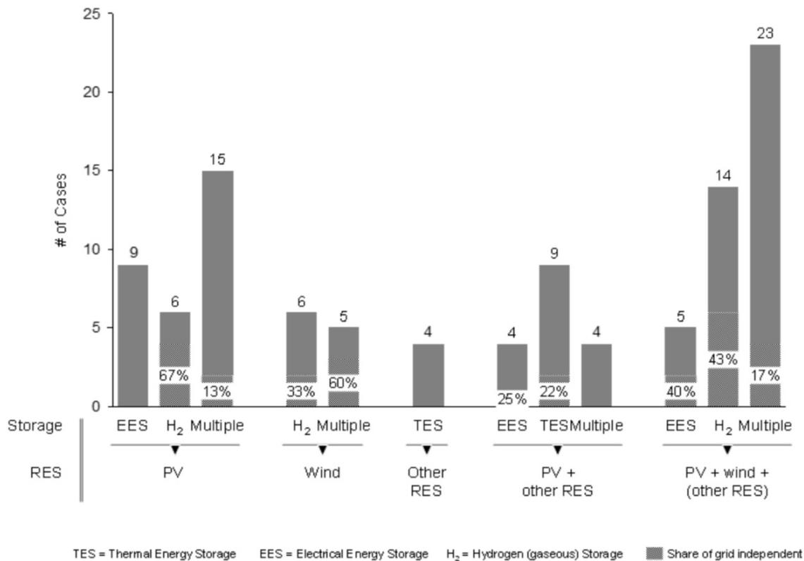
Die Multi-Energiesysteme kategorisiert nach den verwendeten Technologien. In der unteren Zeile sind die Energielieferanten aufgeführt – Photovoltaik (PV), Wind, seltener genutzte Anlagen wie Geothermie oder Solarthermie (Other RES) und Kombinationen davon. Die obere Zeile bezeichnet die Speicher: Batterie (EES), Wasserstoffspeicher (H<sub>2</sub>), Wärmespeicher (TES) sowie Kombinationen von mehreren Technologien. Grosspietsch et al.
