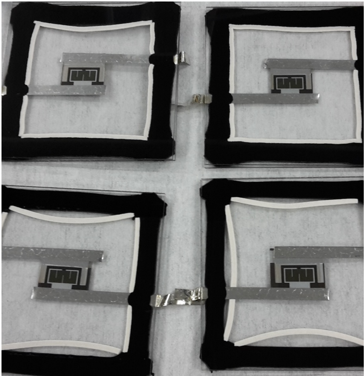
Die Hochskalierung vom Labormassstab zu grossflächigen Solarmodulen ist eine der verbleibenden Hürden zur industriellen Massenfertigung von Perowskit-Solarzellen. Quelle: Final Report
