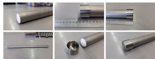
So sieht ein mit Phasenwechselmaterial gefülltes Stahlrohr im Labor aus. Sophia Haussener
