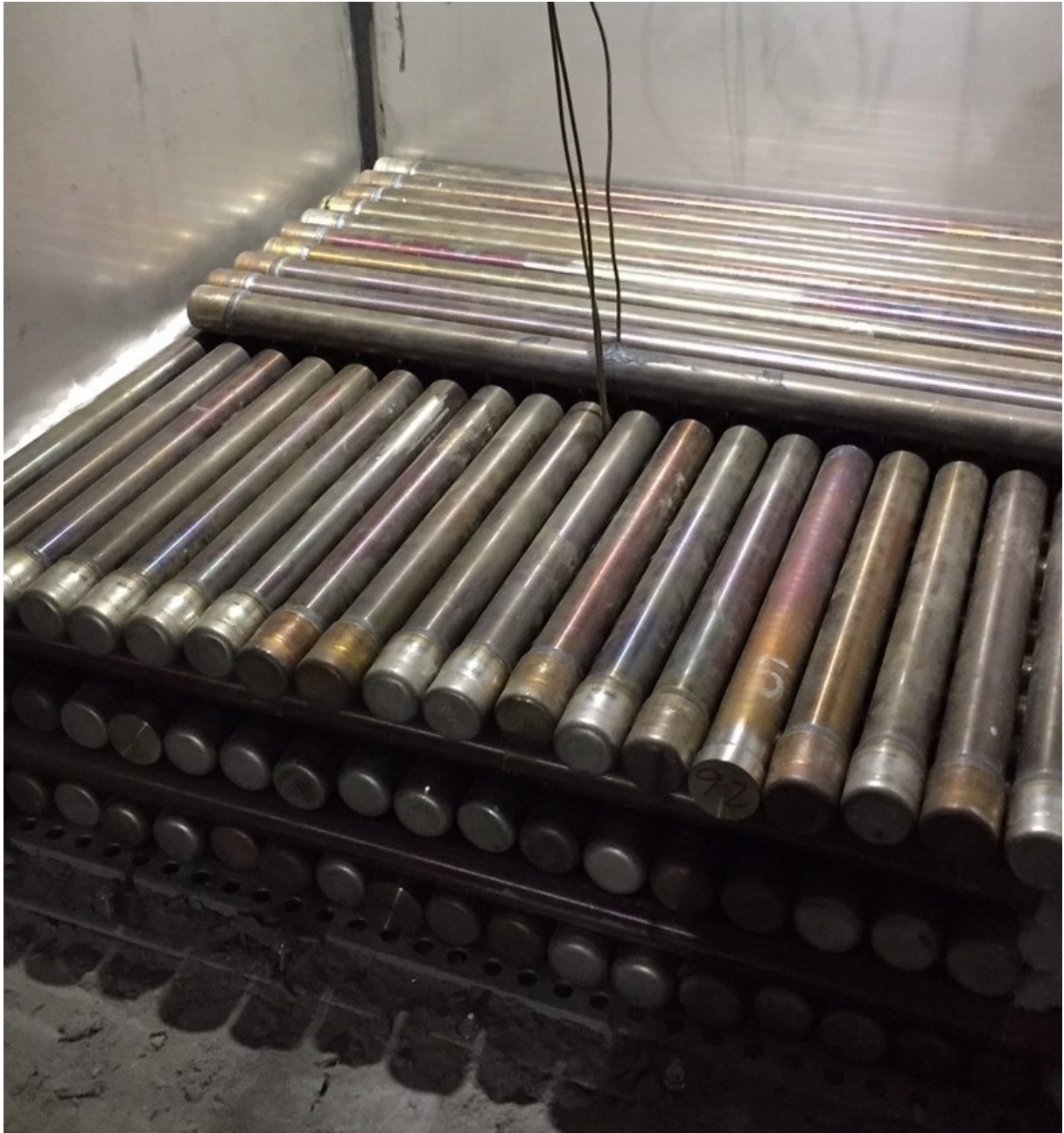
Mit diesem Latentwärmespeicher kann man Wärme einfangen – und so effizienter Strom speichern. Quelle: Viola Becattini
