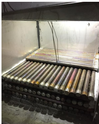
Stahlrohre enthalten eine spezielle Stoffmischung für die latente Wärmespeicherung.
