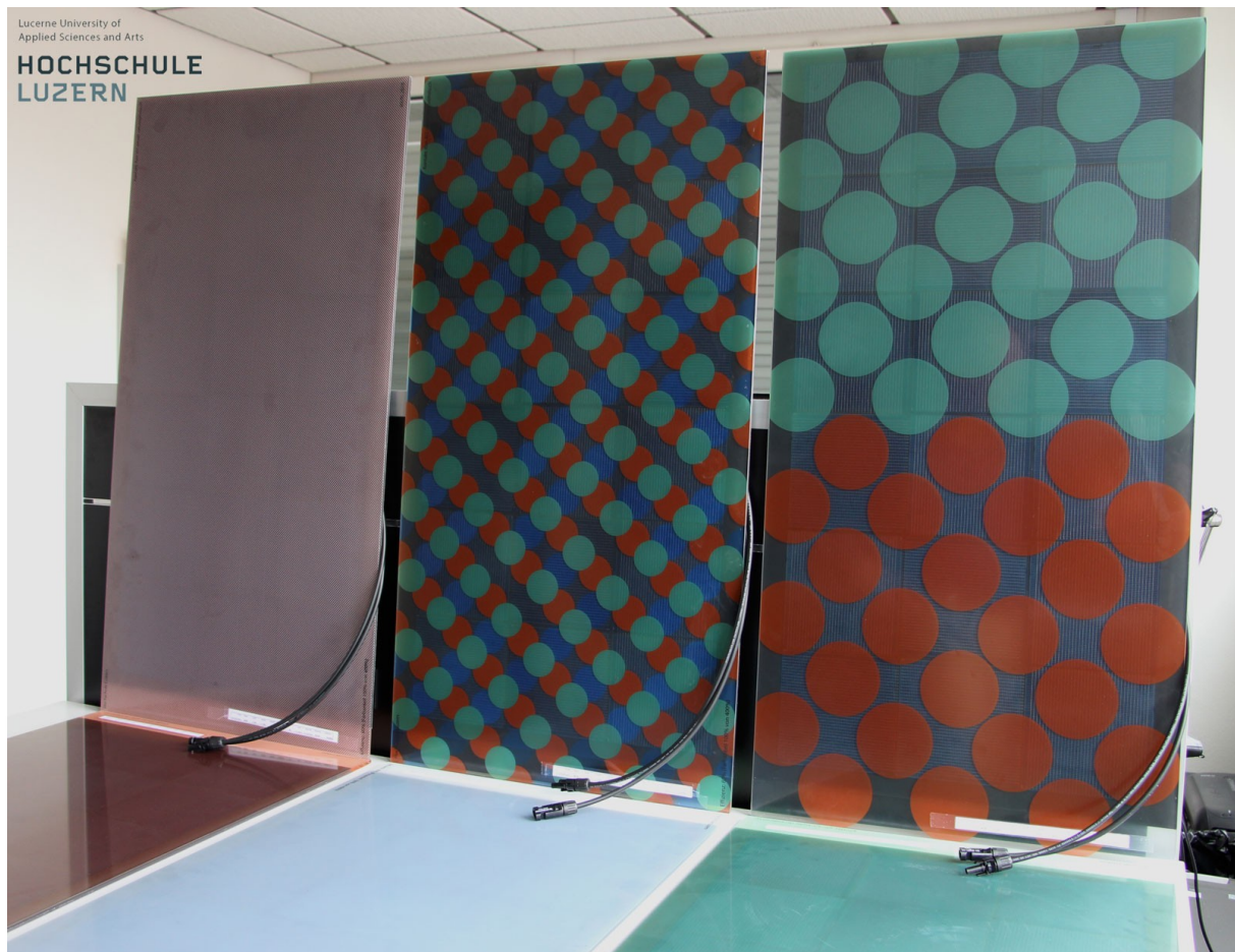
Mit Mustern bedruckte PV-Module. Stephen Wittkopf
